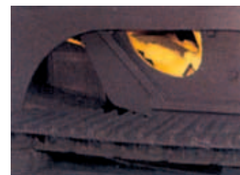
Вырез в стенке со стороны дробилки (с обеих сторон шасси)
